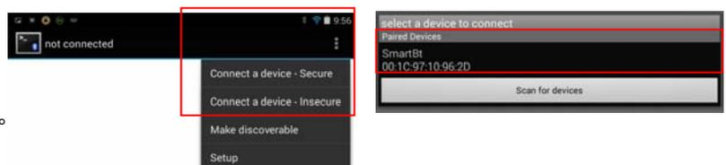
**メモ** スレーブモードは、スリープなどで Bluetooth 切断した場合、再接続するにはデバイスとスキャナ両方の操作が必要です。スキャナのボタンを押して電源オンにし、Bluetooth SPP アプリで接続を行って下さい。
