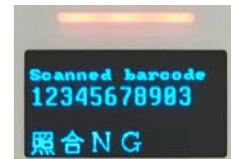
2D/1D バーコードの照合を行えます。最初に読み取ったバーコードと、その後のバーコードが同じか (OK) 違うか (NG) を本体で確認できます。作業後、PC にデータを転送し OK/NG の記録を確認することもできます。
