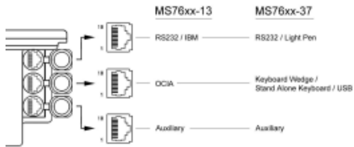
図 20: コネクタの見取図 (上) 補助用スキャナのセットアップ(下)
